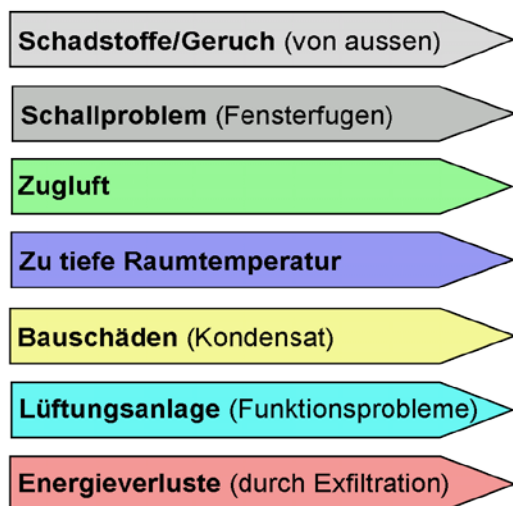
Negative Auswirkungen durch Luftleckstellen
